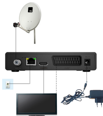
Exemple 3 – Mélange avec connection LAN
